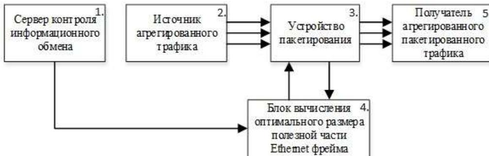
Рис. 4. Функциональная схема способа оптимального формирования фрейма канального уровня для агрегированного трафика в мультисервисной сети передачи данных по критерию минимума сквозной задержки
