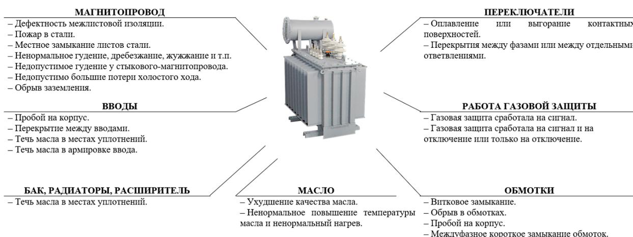
Рис. 4. Классификация характерных повреждений силовых трансформаторов
