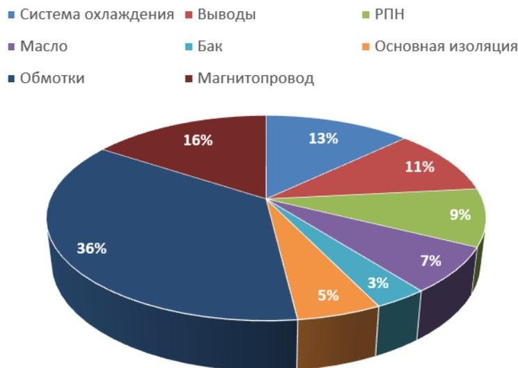
Рис. 5. Статистика распределения повреждений силовых трансформаторов
